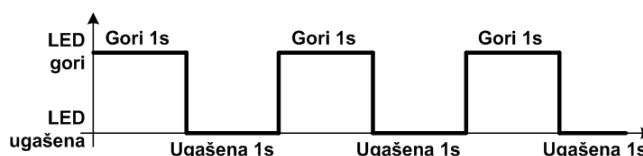
Slika 5: Rad svjetiljke kada je uređaj u režimu «samo topla voda» bez obzira na rad kompresora ili temperaturu vode u bojleru
