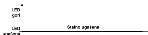
Slika 4: Rad svjetiljke kada je kompresor isključen i voda je zagrijana preko 51°C
